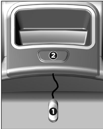
**Рис. 5: Переключатель перезапуска**
